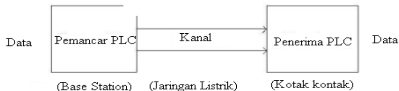
Gambar 1. Komunikasi menggunakan media kabel listrik ( Power line )
