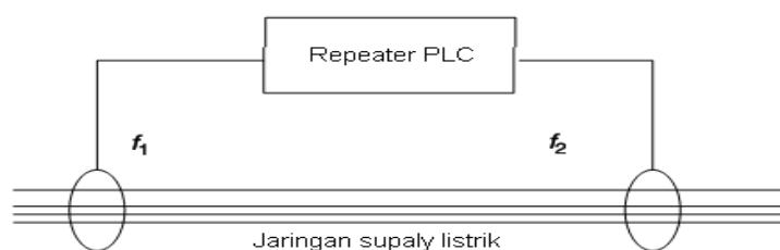
Gambar 5. Pengembangan cakupan PLC dengan menambahkan repeater PLC
